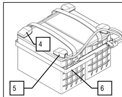
8. Collegare il cavo connettore batterie (5) ai poli terminali "+" e "-" in modo da ottenere ai morsetti una tensione di 24V
