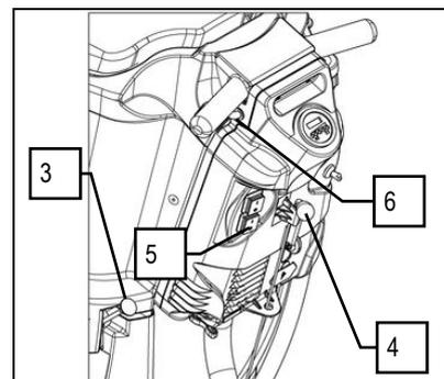
Quando il livello di carica delle batterie sta per esaurirsi, sul display inizia a lampeggiare il simbolo "batteria", il motore spazzole si spegne automaticamente, rimane una carica residua per completare l'asciugatura; è quindi necessario procedere al più presto alla ricarica delle stesse.
