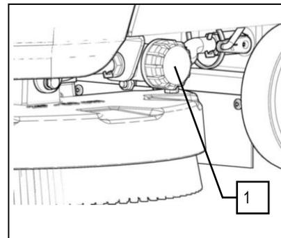
Controllare che il filtro soluzione (2) nella bocchetta di carico, posta nella parte anteriore della macchina, sia posizionato correttamente.
