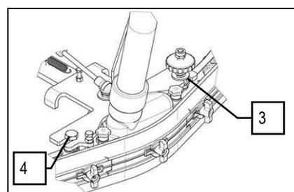
Se la gomma anteriore del tergipavimento è usurata non si ottiene una buona aspirazione e quindi la macchina non asciuga perfettamente, in tal caso per sostituirla (vedere paragrafo SOSTITUZIONE GOMMA ANTERIORE TERGIPAVIMENTO).
